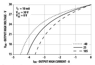
Figure 5. I<sub>OH</sub> vs.V<sub>OH</sub>
