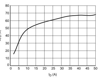
Figure 12. G<sub>FS</sub> vs. I<sub>D</sub>
