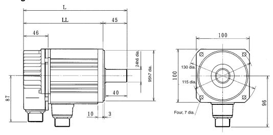
□1.0-kW/1.5-kW/2.0-kW Models With Brakes
