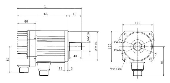
□1.0-kW/1.5-kW/2.0-kW Models With Brakes
